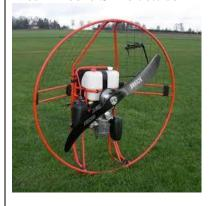
Eignung: Piloten bis 120 kg Propeller 125 cm, 21,5 PS
